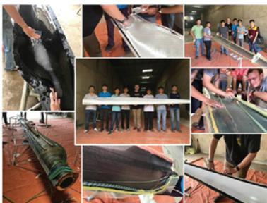
Hình 20: Chế tạo cánh thu nhỏ của cánh DeVie Wind Turbine tại HCMUT-VNU với sự chuyển giao của chuyên gia từ Viện Fraunhofer IWES
