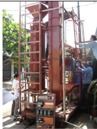
Hệ thống khí hóa đa nhiên liệu thử nghiệm QH-01 (Biomass Lab và Công ty TNHH Điện Hơi Tín Thành, 2013).
