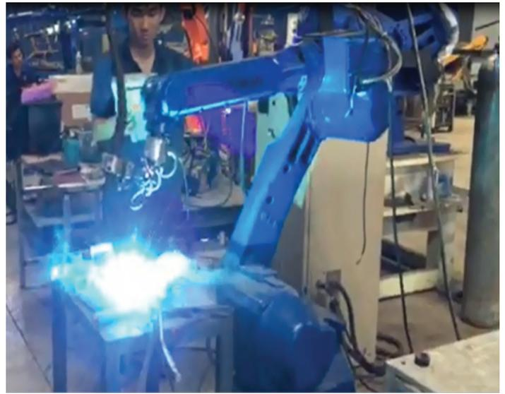
Hình 4. Hình ảnh hoạt động thử nghiệm robot hàn MIG
