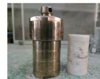
Hình 8: Trang thiết bị phản ứng thủy nhiệt. Nhóm có 16 bộ hấp thủy nhiệt, giúp chủ động quá trình nghiên cứu
