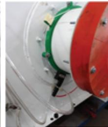
Hình 15: Thử nghiệm đặc tính hoạt động của quạt ly tâm công suất 5.5 kW của Công ty Đồng Tâm
