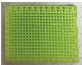
Hình 7: Giá thể PCL tạo hình bằng phương pháp in 3D có cấu trúc lỗ xốp liên thông, ứng dụng làm vật liệu y sinh
