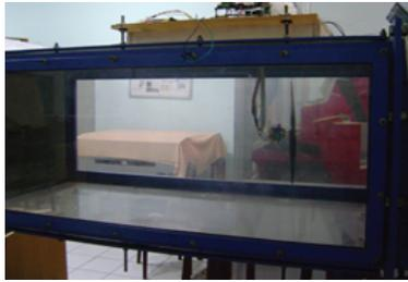
Hình 7: Hệ thống thực nghiệm đặc tính hoạt động của chong chóng khí dùng cho máy bay không người lái loại nhỏ
