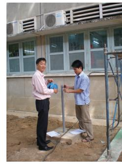
Hình 3. Quan trắc mực nước tại mô hình bổ sung nhân tạo
