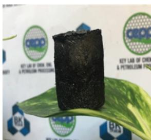
Sản phẩm graphene aerogel của CEPP Lab
