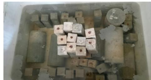
Hình 7. Thử nghiệm sản phẩm xi-măng kháng ăn mòn nước biển SSC
