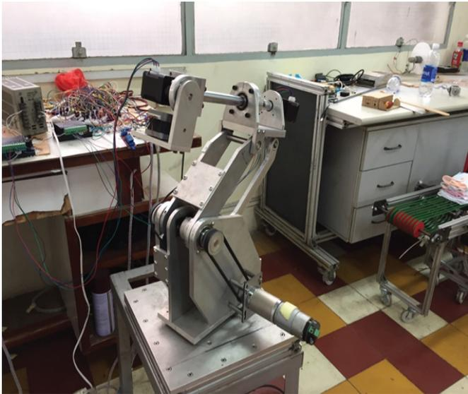
Hình 3. Mô hình robot 6DOF do nhóm chế tạo
