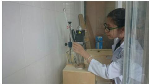
Hình 4. Thí nghiệm nhiệt thủy hóa xi-măng
