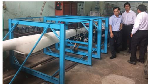
Hình 21: Hệ thống thử nghiệm bên kết cấu cánh của máy phát điện gió trục ngang loại nhỏ
