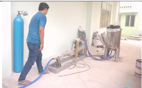
Thử nghiệm khí hóa với tác nhân giàu Oxygen (Biomass Lab và Công ty TNHH Điện hơi Tín Thành, 2016).
