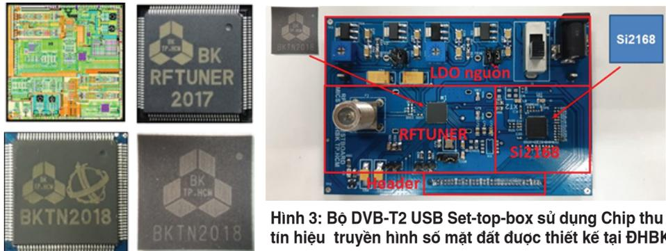
**Hình 3: Bộ DVB-T2 USB Set-top-box sử dụng Chip thu tín hiệu truyền hình số mặt đất được thiết kế tại ĐHBK**
