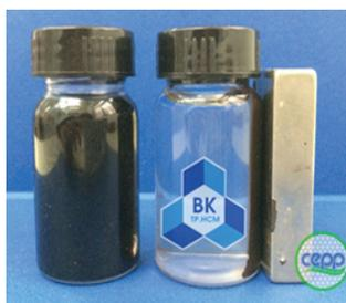
Vật liệu Fe<sub>3</sub>O<sub>4</sub>/graphene oxit
