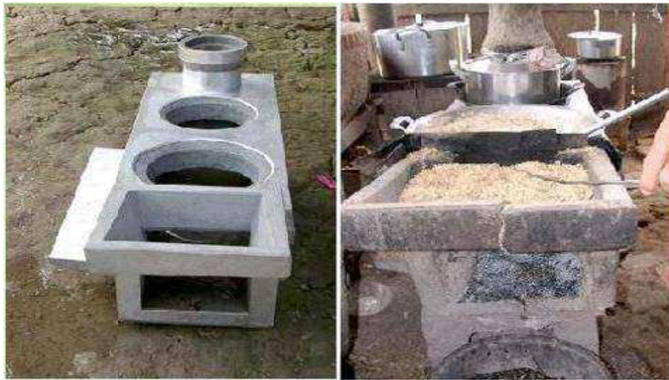
Hình 11: Lò đốt trấu dùng trong sinh hoạt
