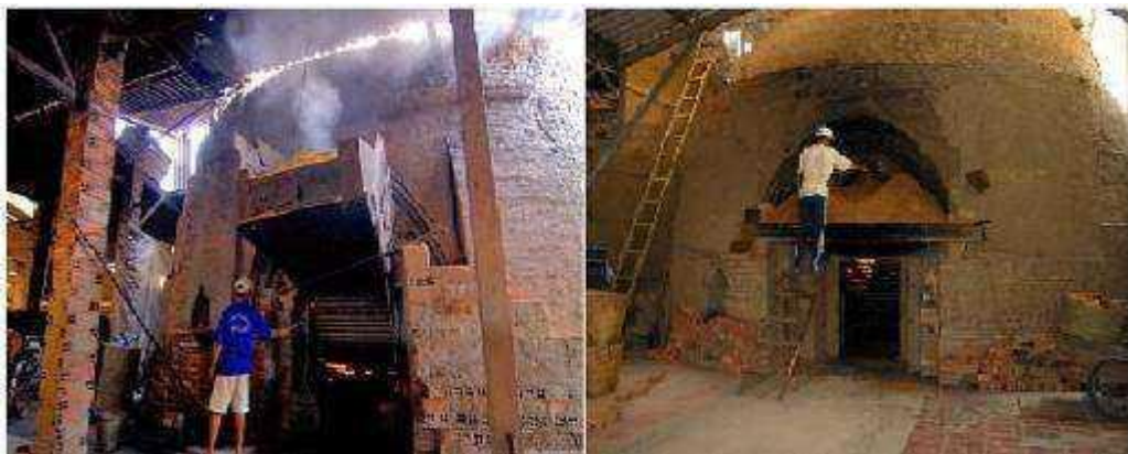
Hình 12: Lò nung gạch sử dụng trấu
