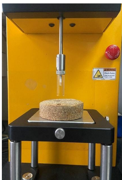
Hình 1. Hình ảnh minh họa phép đo TPA của mẫu thịt chay trên thiết bị Brookfield
