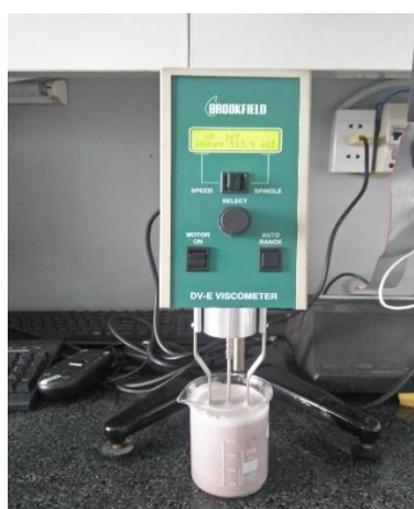
Hình 2. Đo nhớt mẫu thiết bị Brookfield
