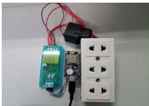
(a) Thí nghiệm đo điện năng AC UART PZEM-004T và ESP8266
