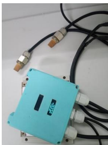
(c) Thí nghiệm đo nhiệt độ và độ ẩm dựa trên cảm biến SHT30 và ESP32/ESP8266 trong hộp
