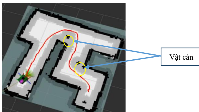
Hình 15. Bản đồ và quỹ đạo di chuyển robot trong môi trường có vật cản cố định
