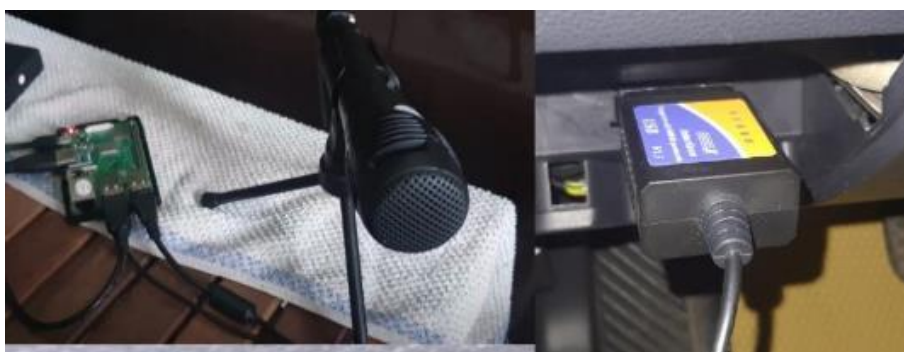
Hình 3. Kết nối Raspberry với ECU thông qua OBD II
