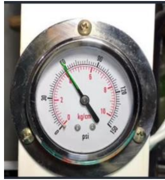
Hình 4. Sử dụng thuật toán HoughLinesP để phát hiện đường thẳng trên kim đồng hồ
