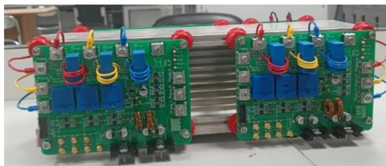
Hình 9. Mạch cảm biến điện áp và dòng điện sau khi thi công
