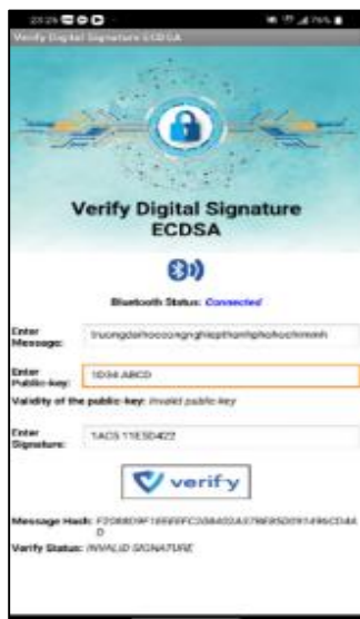
Hình 20. Thử nghiệm Xác minh chữ ký số khi nhập sai khoá công khai
