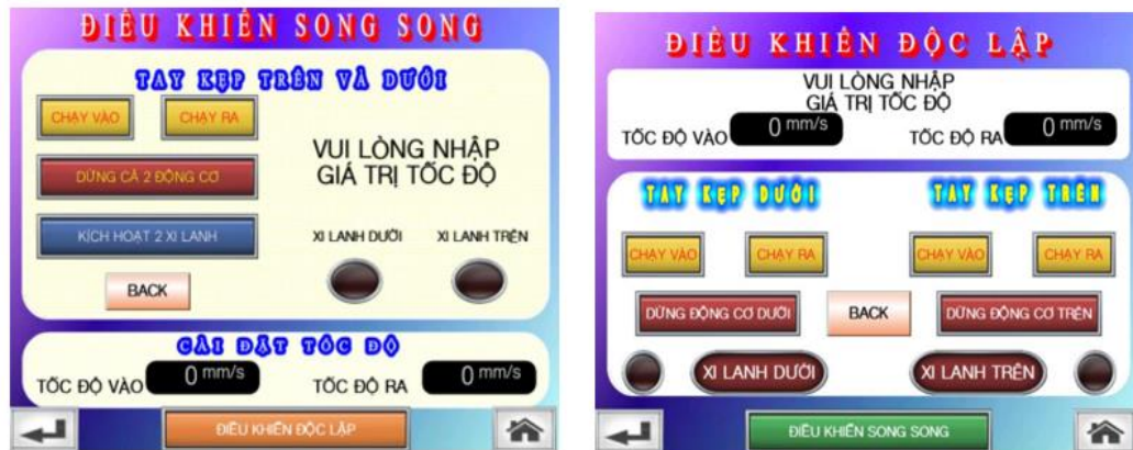
Hình 15. Giao diện điều khiển chế độ bằng tay của mô đun kéo bao
