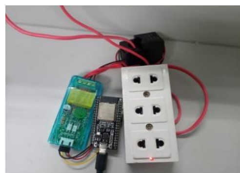
(b) Thí nghiệm đo điện năng AC UART PZEM-004T và ESP32
