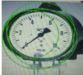
Hình 2. Ảnh minh họa kết quả dùng thuật toán tìm ra các vòng tròn [9]
