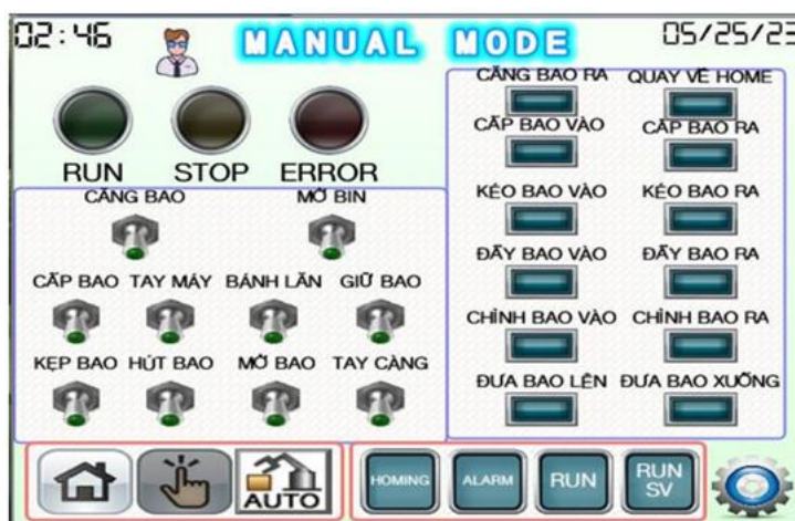
Hình 14. Giao diện điều khiển chế độ bằng tay cho mô đun kẹp và giữ bao
