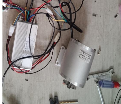
Hình 8: Động cơ điện và bộ điều khiển
