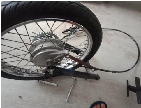
Hình 9: Ráp các bộ phận vào bánh xe
