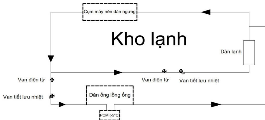
Hình 6: Sơ đồ chu trình nạp tải (tạo băng)
