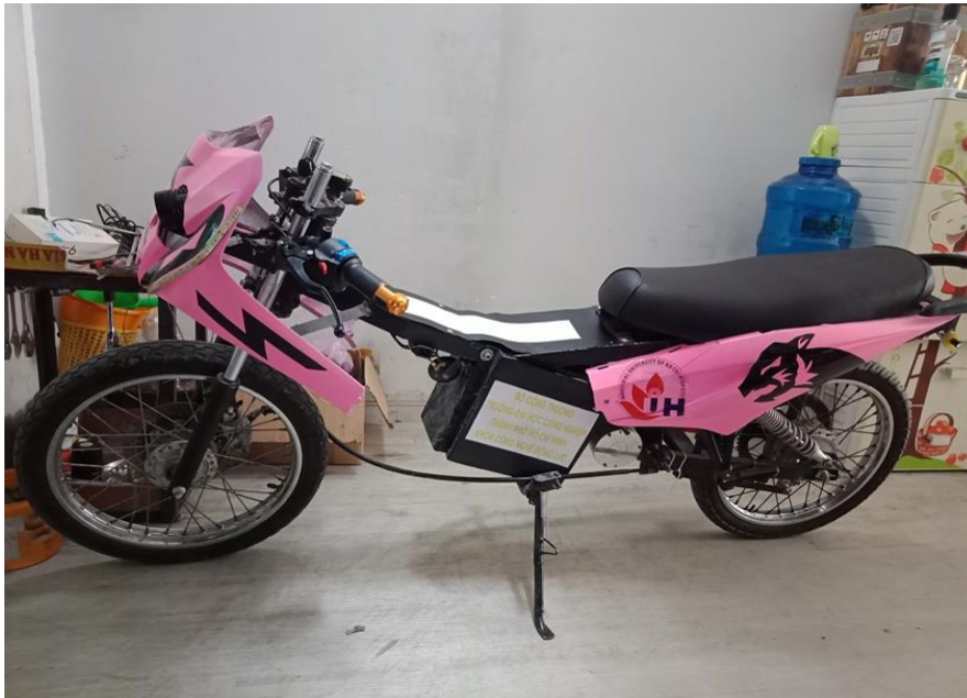
Hình 1: Xe máy điện với hệ thống chiếu sáng và xi-nhan thông minh
