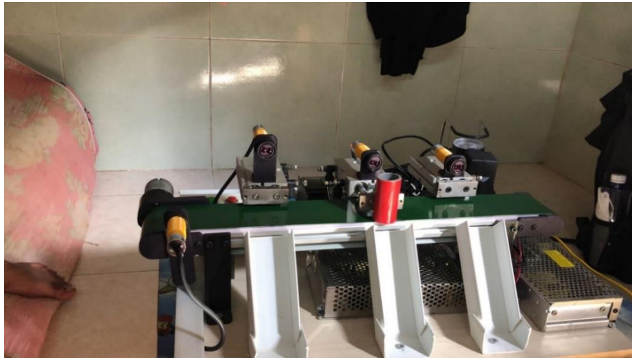
Hình 8. Xylanh đẩy sản phẩm trung bình
