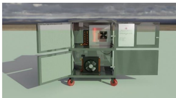
Hình 2. Cấu trúc mô hình máy sấy lạnh sử dụng cho nghiên cứu thực nghiệm theo hình chiếu chính cạnh
