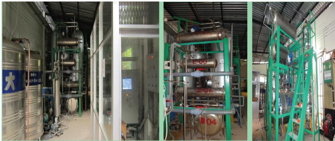
Hình 32: Xưởng công nghệ tự động sản xuất cồn nhiên liệu (99,5%V min) tại RPTC
