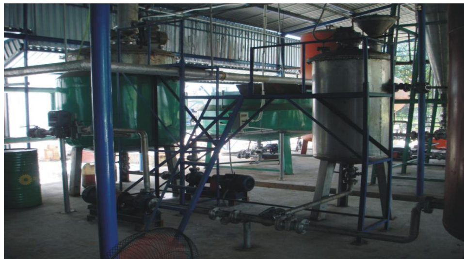
Hình 37: Hình ảnh xưởng sản xuất biodiesel từ dầu ăn phế thải công suất 2000 lít/ngày – RPTC
