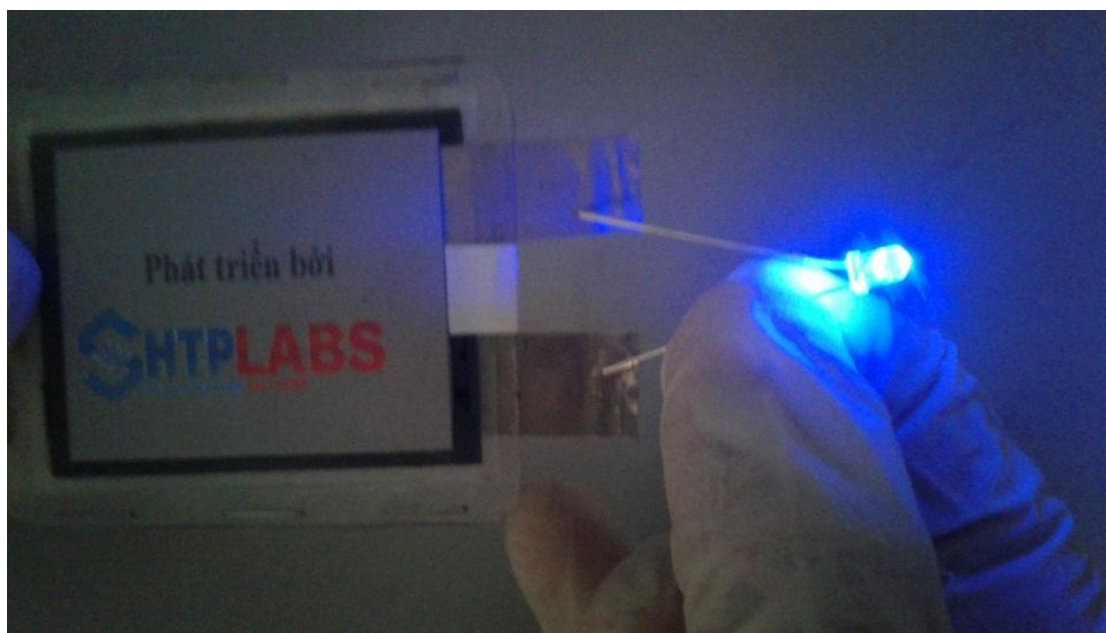
Hình 7: Hình ảnh stack siêu tụ điện ghép bipolar 3 lớp
